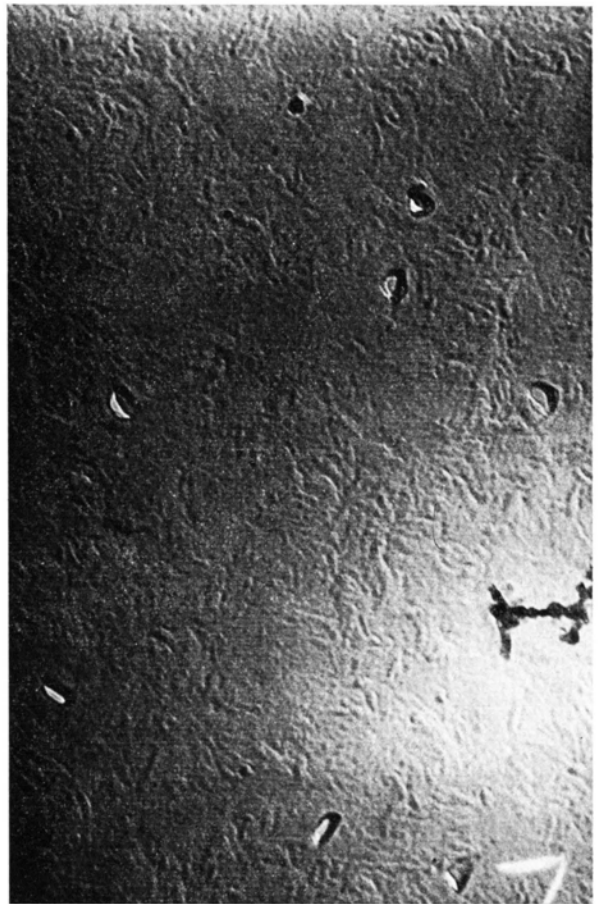
Abb. 3. Oberflächenabdruck einer bestrahlten UO 2 -Schicht (Gesamtvergrößerung 80 000).
